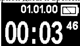
Рис.2.2.6. Установка текущих даты и времени производится из внешнего ПО через USB или Bluetooth.
